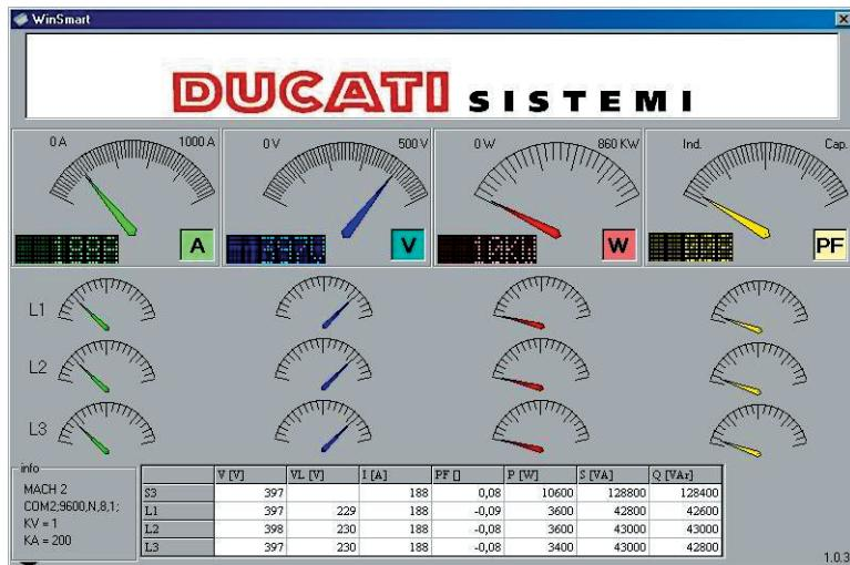
Il programma **Winsmart** è un semplice pacchetto software che consente di visualizzare alcune delle principali misure effettuate dagli Strumenti Ducati e disponibili tramite l'interfaccia seriale RS485 e l'interfaccia Ethernet dei medesimi:
