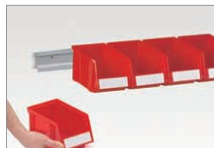
Кронштейн для ячеек 700. Крепеж для подвеса на стену. Допустимая нагрузка - 50 кг. Длина кронштейна 700 мм. Стальной кронштейн покрыт эпоксидно-порошковой эмалью серого цвета. Аксессуары: навесные штабелируемые ячейки и лотки 1015-1930, заказываются отдельно.
